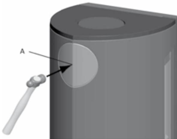
4. Выдавить заглушку проема для отвода обработанных газов в задней стенке (Рис. 6b А).
