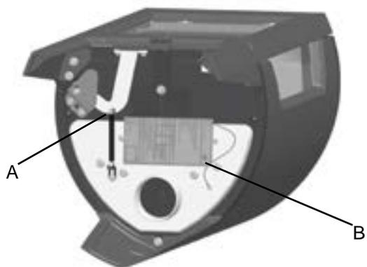
1. Открутить болт и гайку (Рис. 3А).
