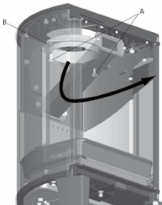
2. Выкрутить болты А (Рис. 5А) и снять дымовой патрубок В (Рис. 5В) в верхней части камеры горения.
