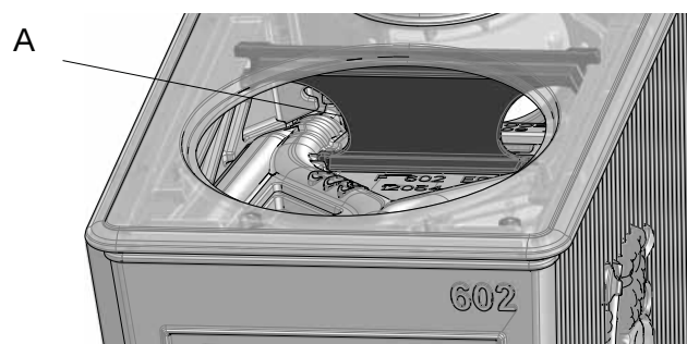
Fig. 27 Sustitución del deflector de escape
